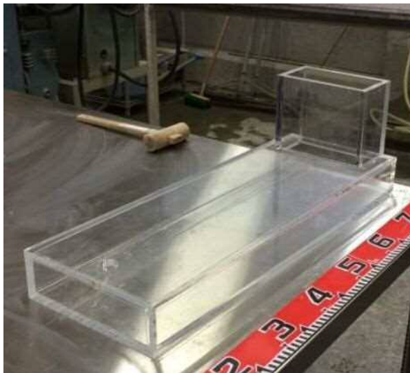
写真一解 4.6 間詰めモルタルの流動性確認試験
