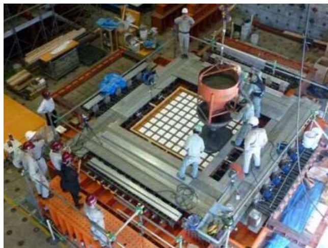
写真一解 4.3 Wッフル型 UFC 床版の試験体打設状況
