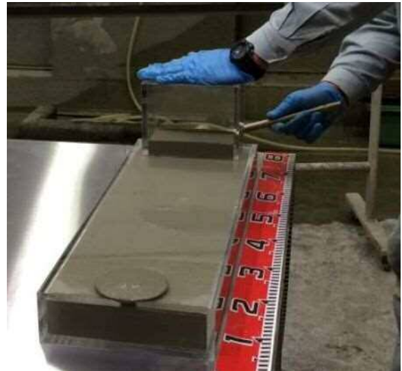
写真一解 4.6 間詰めモルタルの流動性確認試験
