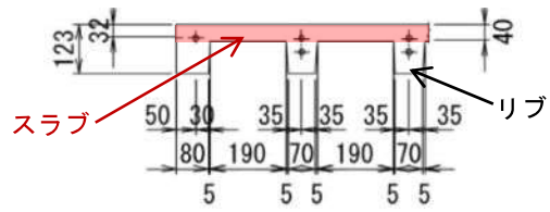
図一解 1.3 ワッフル型 UFC 床版の断面図（単位：mm）
