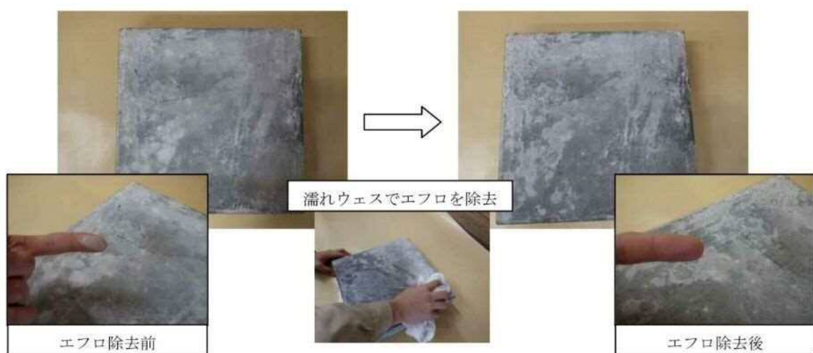
写真－解 4.12 UFC 床版上のエフロレッセンス除去前後
