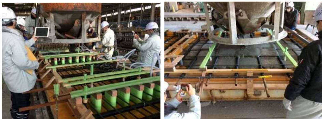
写真一解 4.4 平板型 UFC 床版の試験体打設状況
