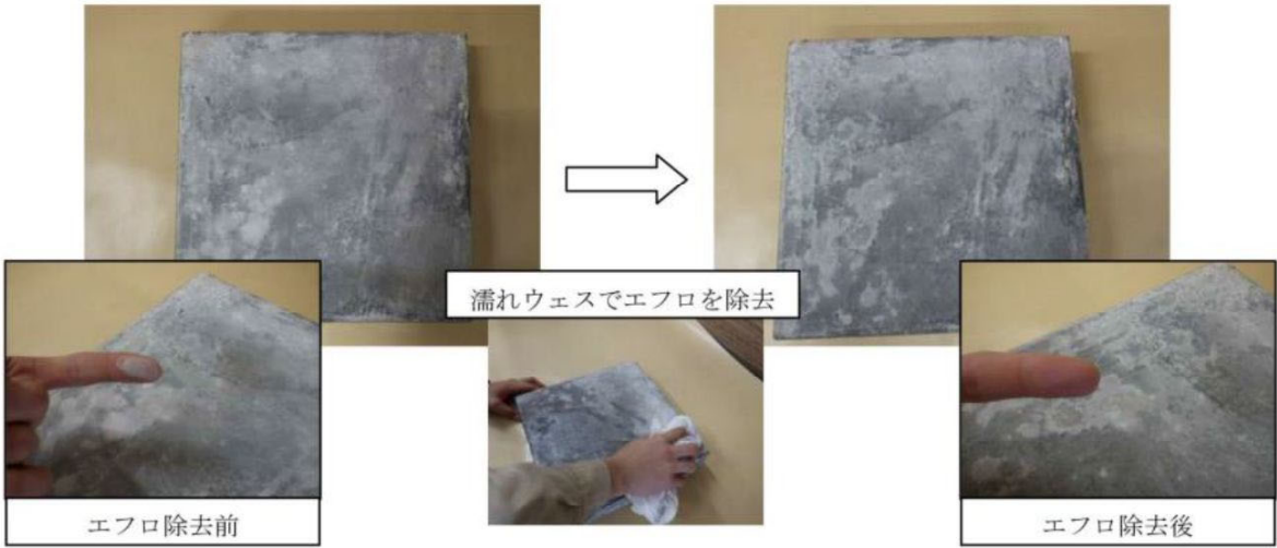
写真一解 4.12 UFC 床版上のエフロレッセンス除去前後
