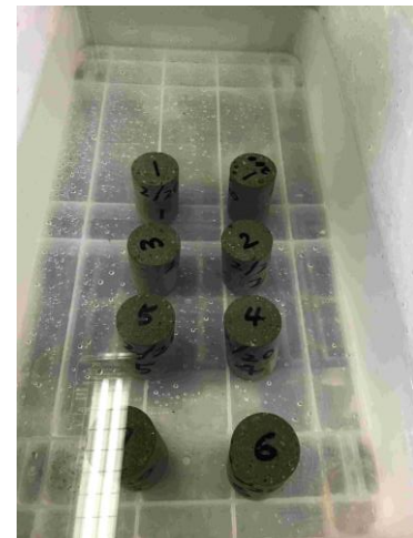
水中浸け置き (異常膨張確認試験)
