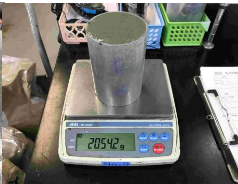
空気量試験 (質量方法)
