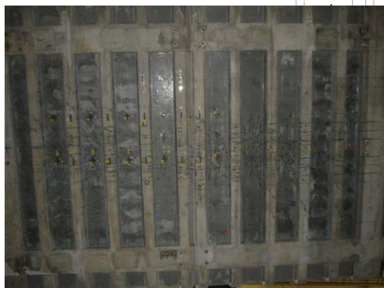
試験体下面のひび割れ状況 (試験終了時)
