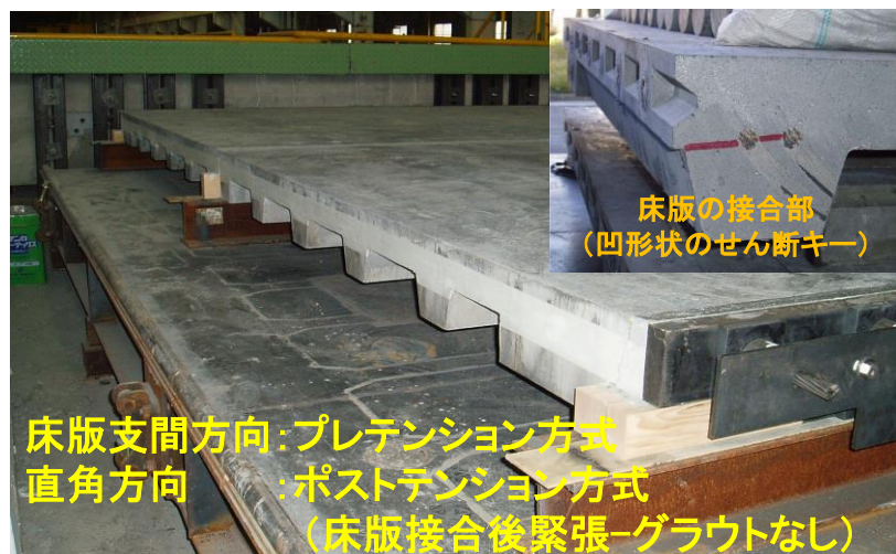
1方向リブ付きタイプ: 平均床版厚105mm (リブ高: 80mm、全高: 160mm、リブ間隔: 400mm)
